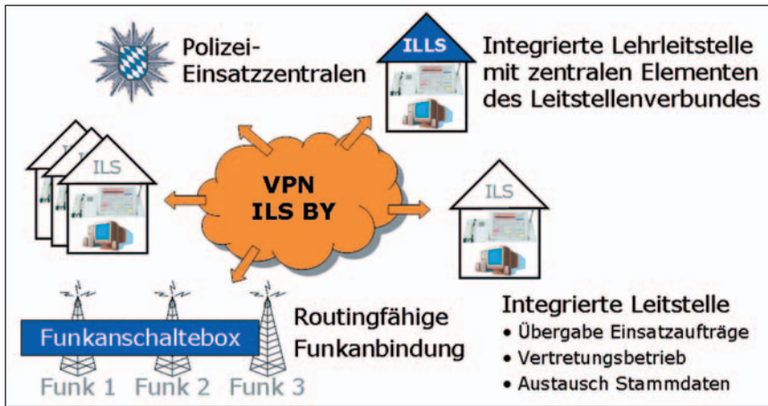
Vernetzung im Leitstellenverbund. Die Integrierten Leitstellen in Bayern werden über ein Virtual Private Network (VPN) miteinander vernetzt. Das VPN wird beispielsweise zur Übertragung von Funkgesprächen oder zur Übertragung von GPS-Informationen der Einsatzmittel verwendet und ermöglicht die Zusammenarbeit und gegenseitige Unterstützung der Integrierten Leitstellen in Bayern.
