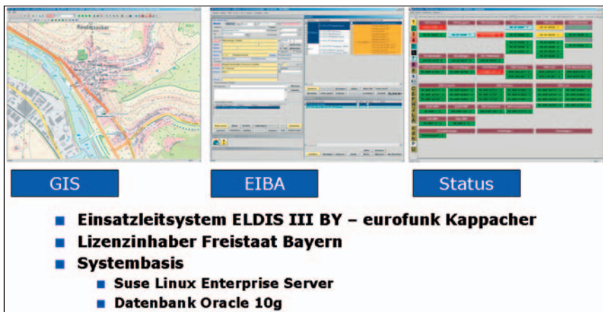
Die Software »ELDIS III Bayern«. Hier zu sehen sind das grafische Informationssystem, die Einsatzbearbeitungsmaske und der Statusschirm der bayernweit einheitlichen Einsatzleitsoftware »ELDIS III Bayern«.
